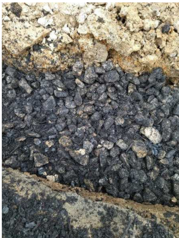
Obr. 16. Štruktúrálny substrát, kamenivo s biouhlím, jedna z možností zlepšenia prekoreniteľnosti koreňového priestoru, zabraňuje zhutňovaniu a zlepšuje retenčnú schopnosť substrátu.
