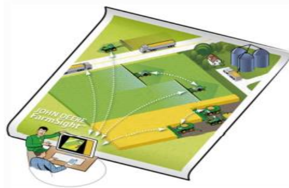
Obr. 30 Monitorovanie strojov pomocou GPS umožňuje manažérovi sledovať techniku na diaľku
