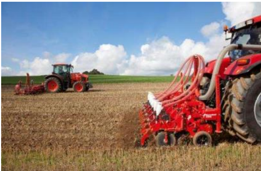
Obr. 51 Strip till prebieha v dvoch operáciách príprava pôdy a sejba
