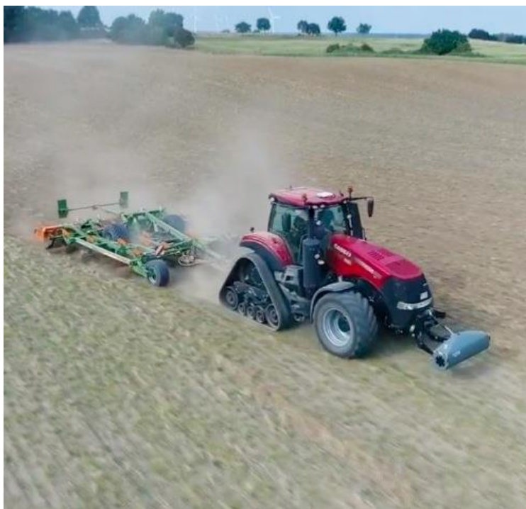
Obr. 47 Kyprič Amazone v kombinácii s traktorom Case so zariadením SoilXplorer
