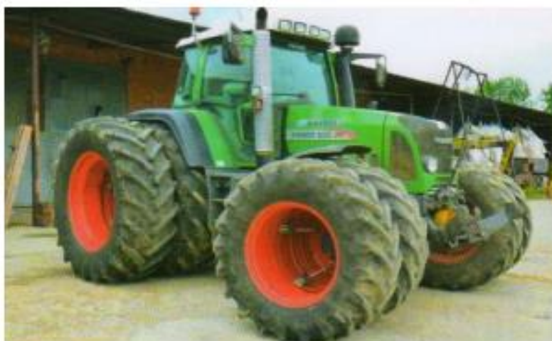
Obr. 25 Detail dvojmontáže pneumatík
