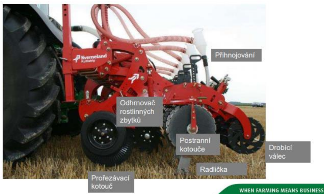
Obr. 53 Hlavné časti stroja pre pásové obrábanie pôdy: 1. Prerezávací kotúč, 2. Odhrňovač rastlinných zvyškov, 3. Radlička, 4. Postranné kotúče, 5. Aplikátory hnojiva, 6. Drobiaci valec
